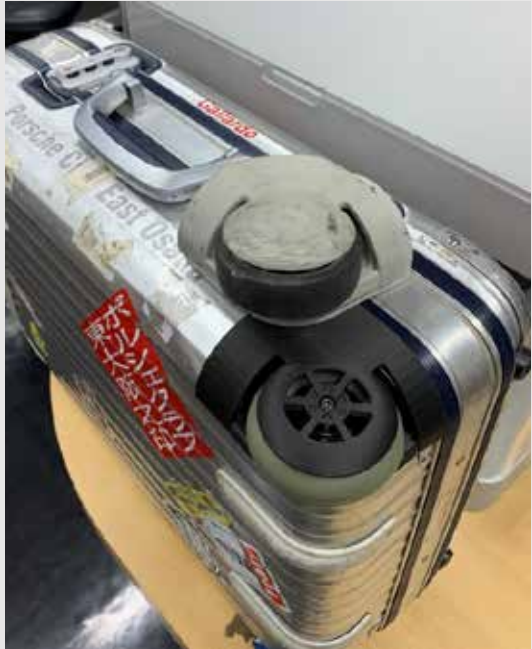
キャスターのベアリング化 とカーボン強化パーツ
