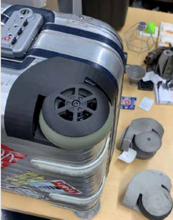
キャスターのベアリング化 とカーボン強化パーツ
